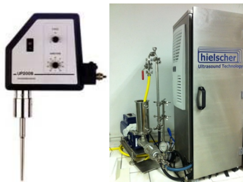
US generators (400 and 1000W) with flow cells - Hielscher (D)
